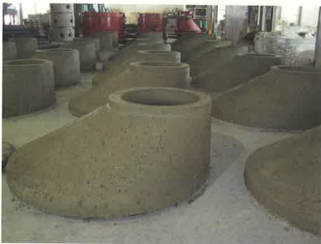
Die neue Schachtring- und Konusfertigung auf der Variant 2000 C wurde nach dem gleichen Prinzip der bestehenden Maschine konfiguriert: mittlere Stückzahlen mit Nennweiten bis 2.000 mm und Transport der Produkte im Formmantel zum Abbinde-Platz.
