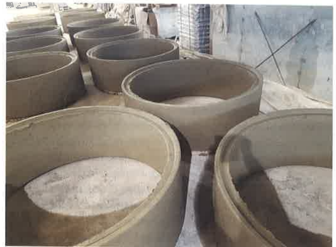
Die neue Schachtring- und Konusfertigung auf der Variant 2000 C wurde nach dem gleichen Prinzip der bestehenden Maschine konfiguriert: mittlere Stückzahlen mit Nennweiten bis 2.000 mm und Transport der Produkte im Formmantel zum Abbinde-Platz.
