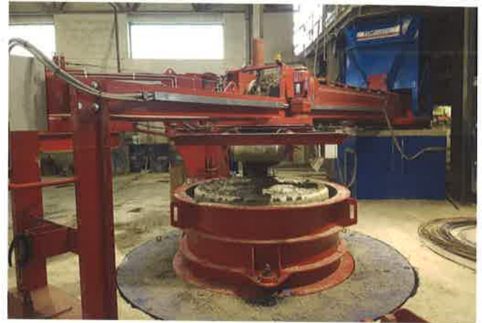
Die Prinzing Pfeiffer Variant ist ein individuell anpassbares Maschinenkonzept zur Herstellung von Beton-, Stahlbetonrohren (rund und nicht kreisrund, mit oder ohne Sohle), Inlinerohren, Vortriebsrohren, Rahmenelementen, etc.
