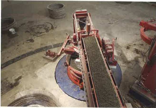
Die Prinzing Pfeiffer Variant ist ein individuell anpassbares Maschinenkonzept zur Herstellung von Beton-, Stahlbetonrohren (rund und nicht kreisrund, mit oder ohne Sohle), Inlinerohren, Vortriebsrohren, Rahmenelementen, etc.
