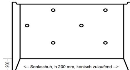
Liefern und Einbauen eines **Abteufringes mit Falz KÜHNE-IDEAL®**, **Nennweite D=1500 mm**, zum Abteufen/Absenken eines Schachtes und zum zeitgleichen Ausheben von Erdreich aus dem Schachtinneren, aus Schachtmaterial nach DIN 4034/2, nach Herstellerzeichnung und Versetzanleitung, bestehend aus:
